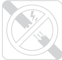
Patikrinkite, ar nepažeisti laidai
