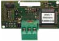
**LON – Schnittstelle für WRS-K** zum Einstecken am Regler KLM zur Kommunikation zwischen der Regelung und der Gebäudeleittechnik unter Verwendung von LON – Standard – Netzwerkvariablen ausgeführt als Steckkarte, in der DDC-Regel- und Steuereinheit integriert. Transceiver FTT-10A / 78 kbit/s. Anschluss über Steck-Schraub-Klemmen. Die Einbindung des Moduls in die bestehende GLT erfolgt bauseits.
