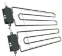
**Elektro-Vorheizregister;** einstufig zur Filtervorerwärmung; schaltet selbständig unter +5°C zu; im CRL Grundgerät nachrüstbar
