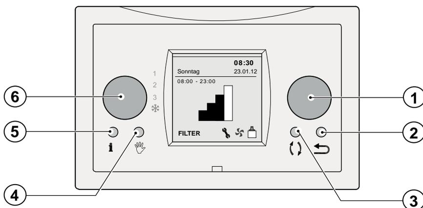
Das Bedienmodul BML Excellent (Zubehör) ist mit 6 Tastern/Tasten ausgeführt. Diese haben beim Gerät CWL - F - 150 Excellent (VHZ) folgende Funktion:
