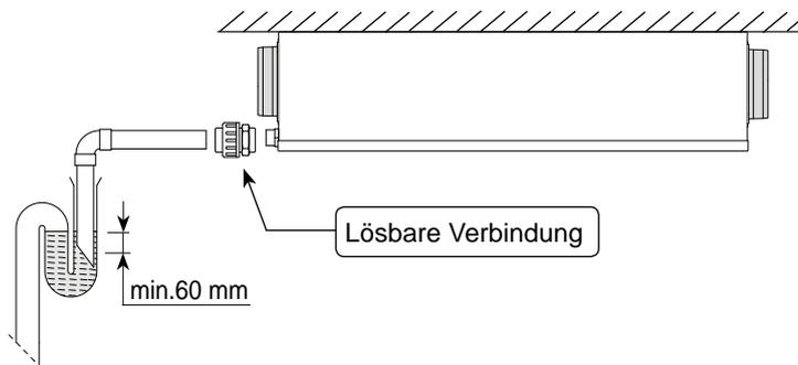
Kondensatablauf bei Deckenmontage CWL - F - 150 Excellent (VHZ)
