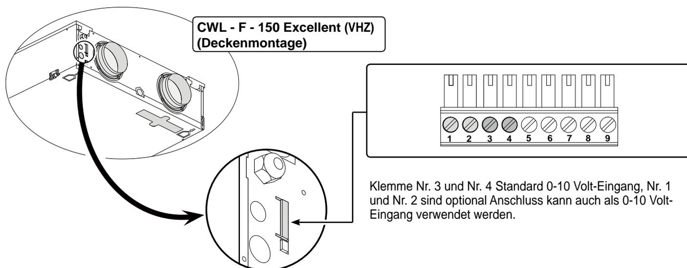
Wenn noch ein zweiter 0-10V-Eingang notwendig ist, können erforderlichenfalls der Anschluss Nr. 1 und Nr. 2 des 9-poligen Steckers X15, die standardmäßig als Schaltkontakt vorprogrammiert sind, auf einen zweiten 0-10V-Eingang umprogrammiert werden. Durch Umstellen der Schrittnummer 14 von 'AUS' auf 'EIN' wird dieser Eingang ein proportionaler 0-10V-Eingang. Bei Anwendung zweier 0-10V-Eingänge hat der 0-10V-Eingang mit dem höchsten Luftdurchsatz immer Priorität.
