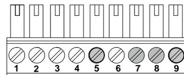
Klemme Nr. 5 (GND) und 9 (0-10V-Ausgang) für die Steuerung Erdwärmetauscher; Klemme Nr. 7 und 8 für Temperaturfühler (10 kΩ)
